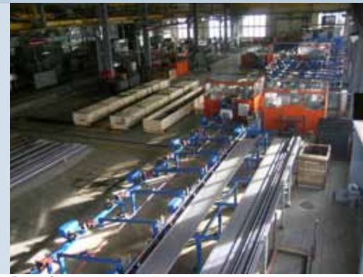
Производственный комплекс №1. Автоматическая линия сборки термостабилизаторов
