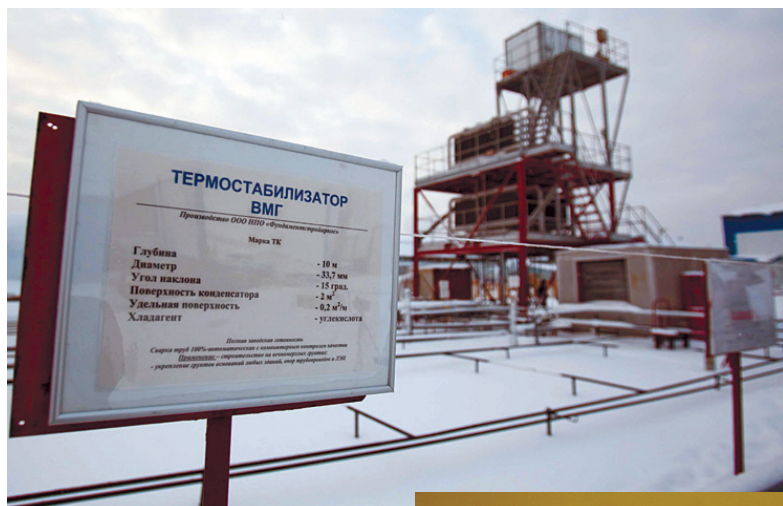
Научно-исследовательский полигон с различными видами термостабилизирующих устройств
