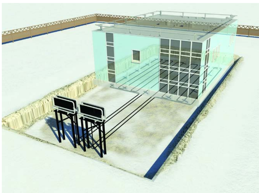
Система ГЕТ включает размещенные под теплоизоляцией горизонтальные охлаждающие и соединительные трубы (подземная часть) и конденсаторный блок (наземная часть)
