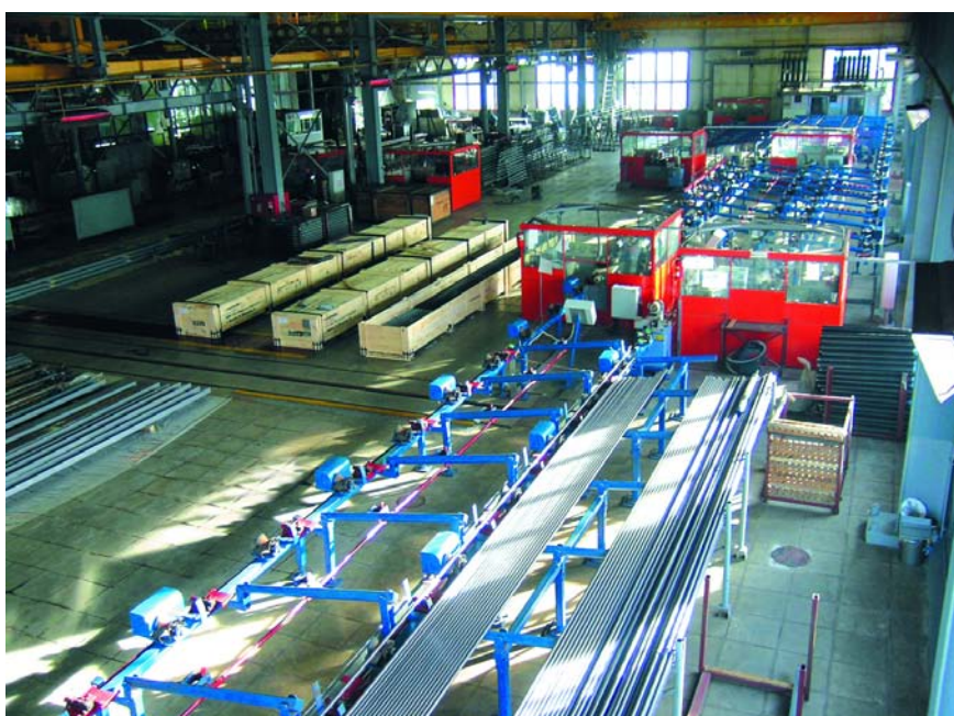
Автоматическая линия по производству термостабилизаторов
