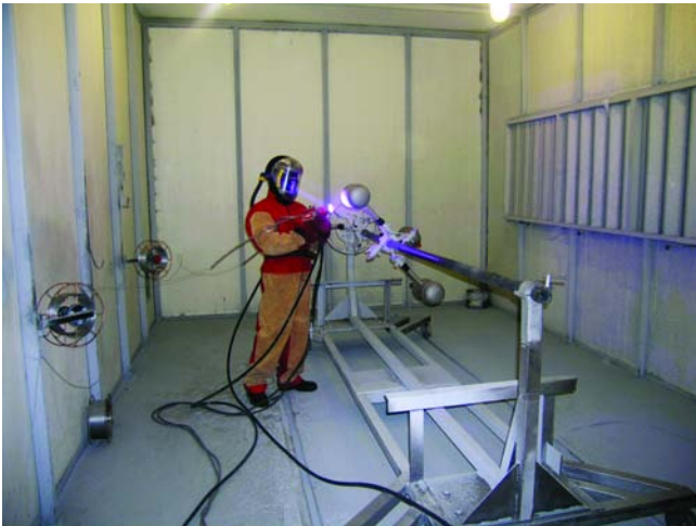
Камера оцинкования подземных элементов систем
