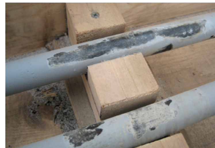
Рис. 4. Повреждение покрытия корпуса термостабилизатора в процессе транспортировки из-за неправильной упаковки
