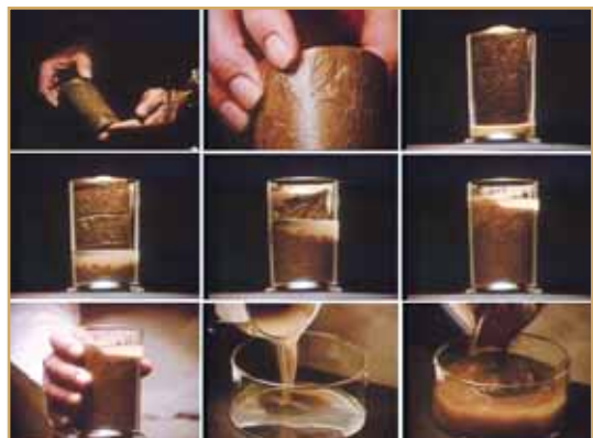
Рис. 2. Потеря несущей способности грунтов оснований
