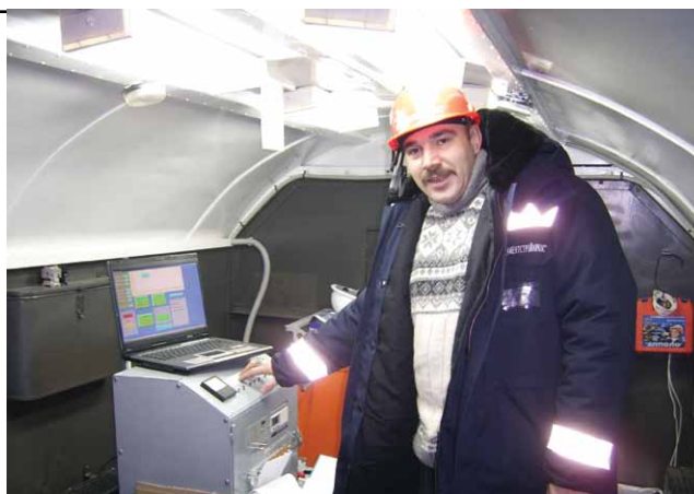
Рис. 3. Оператор автоматической сварочной установки. Связь со сварщиком производится посредством радиосвязи
