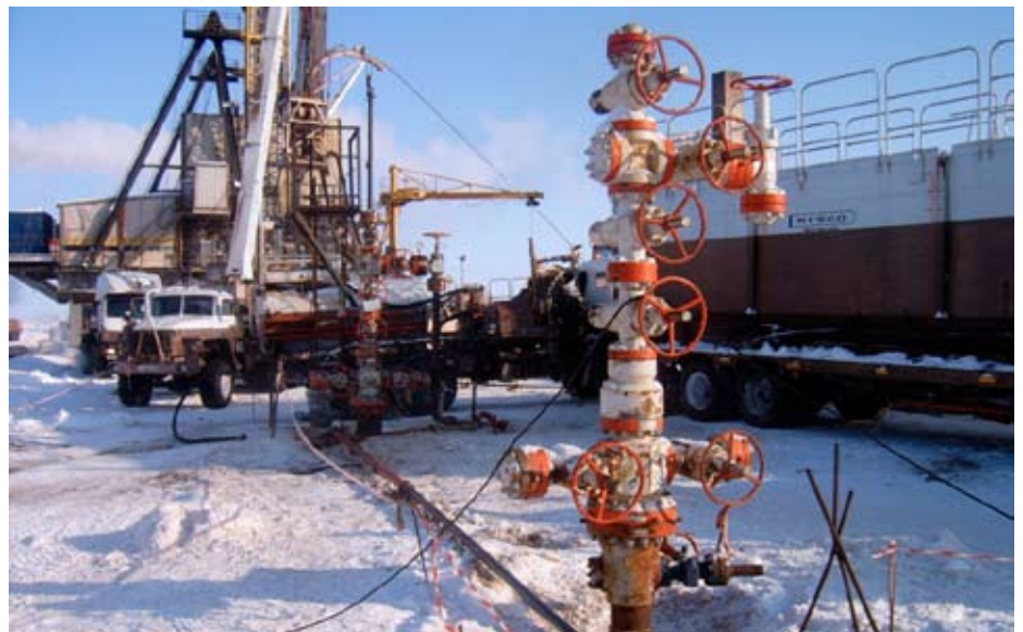
На нефтедобывающих скважинах пока не установлены системы ТСГ, но растепление вечномерзлых грунтов началось уже в процессе бурения и обустройства скважин
